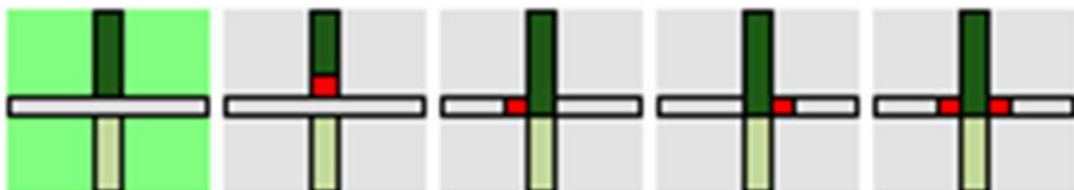
Bild 208 Stoßstellen mit Entkopplungsschicht(en)
