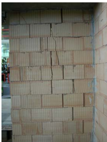
Bild 4: Schubwand des Prüfkörpers B1 (Plan-HLz 12) nach Belastung mit nom\ a_g = 1,8\ m/s^2
