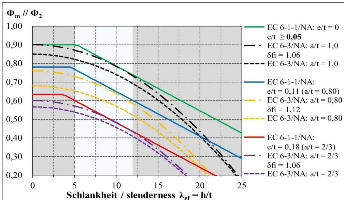
Bild 2: Vergleich der Abminderungsbeiwerte  $\Phi_m$  nach DIN EN EN 1996-1-1/NA und  $\Phi_2$  nach DIN EN 1996-3/NA für verschiedene Verhältnisse  $a/t$  [7]
