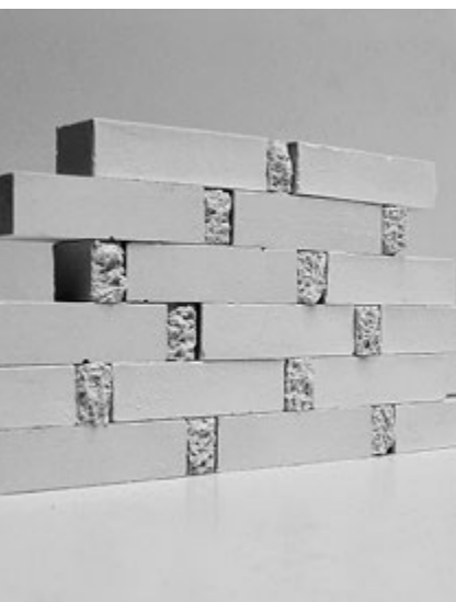
▲ Ergebnis der Materialstudien: entwickelte Backsteine im Fassadenmodell.
